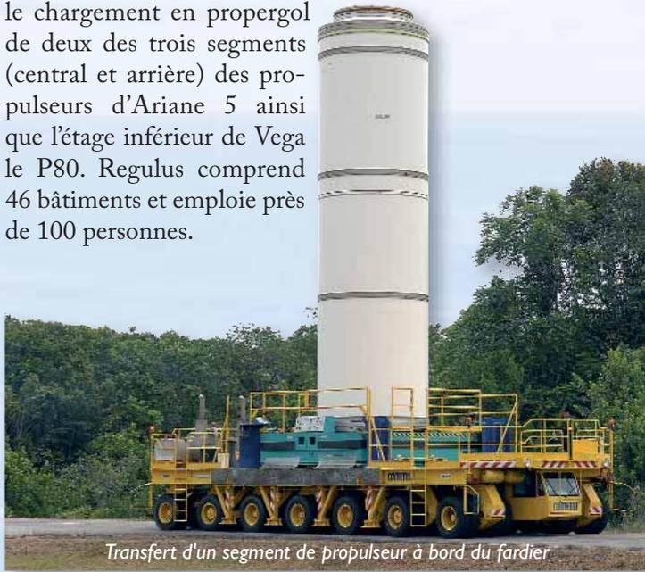
Transfert d'un segment de propulseur à bord du fardier
